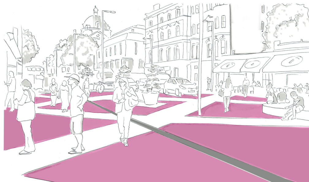
Abbildung 84: London. Exhibition Road löst mit einer ebenen Pflasterung viele wichtige Aspekte einer inklusiven Straßenraumgestaltung im Design für Alle. Bild: Sören Jungclaus, Büro grauwert basierend auf Marston (Holdings) Limited. Quelle: Exhibition Road
