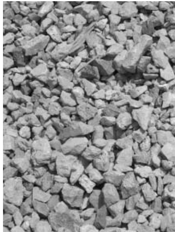
Abb. 9: Recyclingmaterial – sortenrein zerkleinerter Bauschutt
