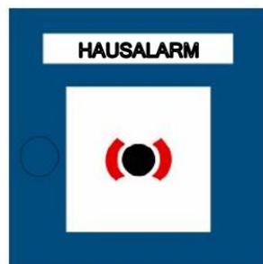
Auslösestelle für den Hausalarm ohne Aufschaltung zur Feuerwehr
