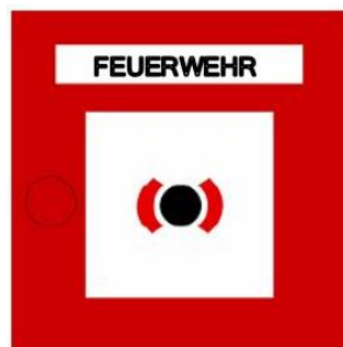
Handfeuermelder mit Aufschaltung zur Feuerwehr
